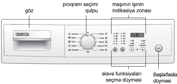
Şəkil 1 – İdarəetmə paneli
